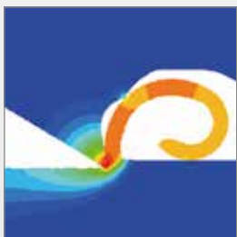
Nuevo diseño de dientes con rompevirutas
