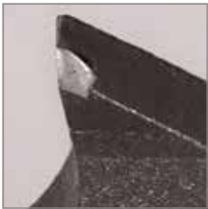
Diente con daños, sin rodaje
