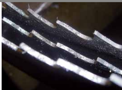
Adherencia de virutas en la base del diente
