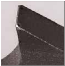
Diente sin daños, tras el rodaje
